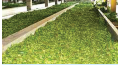
1. Aşama: Çay yapraklarında bulunan su, sıcak hava ile buharlaştırılır. Çay yaprağı, renk ve koku özelliklerini korur.
